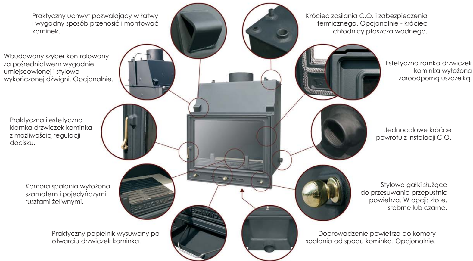
rys.4 Detale wkładu kominkowego z zespołem wodnym typu LECHMA PL-190
